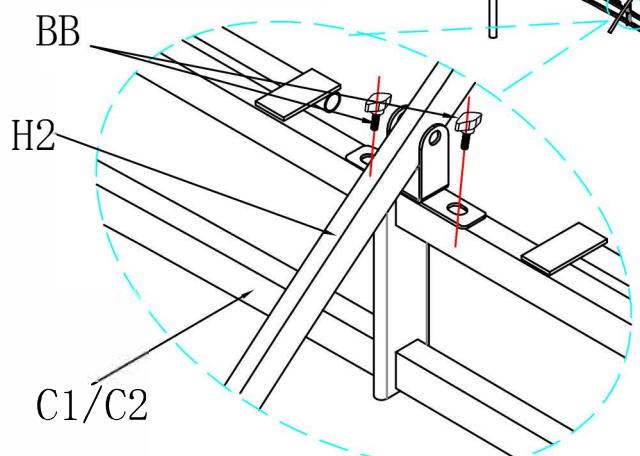
Montez cette pièce avec la poutre (C1/C2) au bout de H2 par les vis BB.
