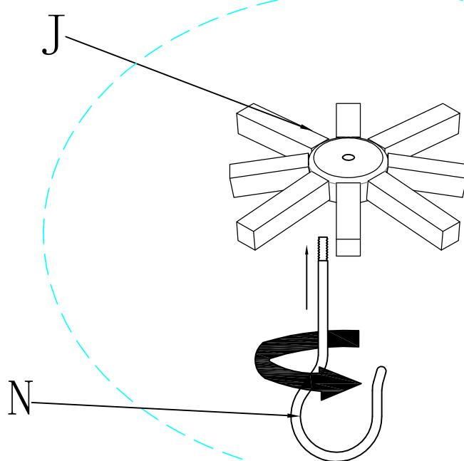
Connectez le crochet N au connecteur supérieur J.
