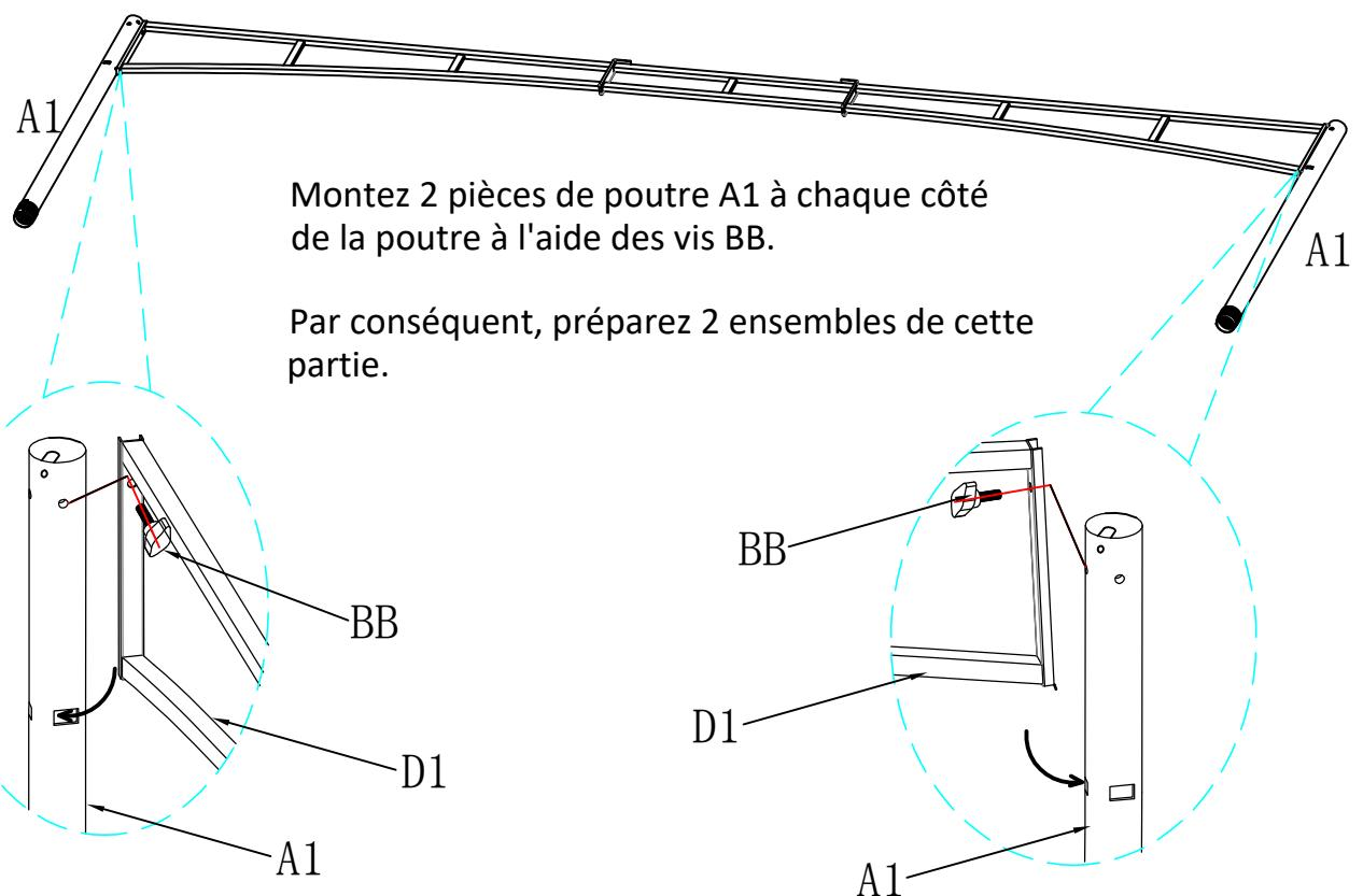
Montez 2 pièces de poutre A1 à chaque côté de la poutre à l'aide des vis BB.
