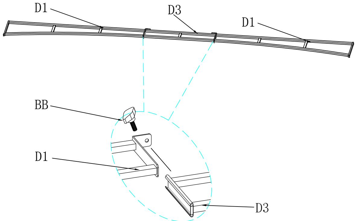
Montez 2 pièces de poutre D1 à chaque extrémité de poutre D3 à l'aide des vis BB.
