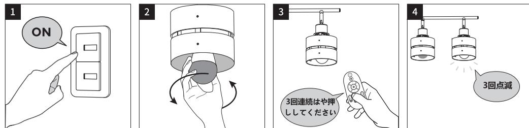
壁スイッチなどで登録したい照明器具の電源を一度切れます。数秒経ってから電源を入れ直します。
