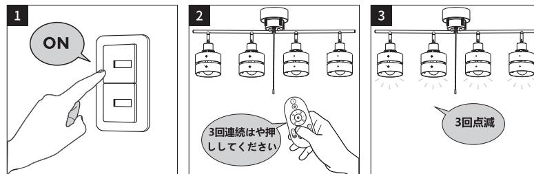
壁スイッチなどで登録したい照明器具の電源を一度切れます。数秒経ってから電源を入れ直します。
