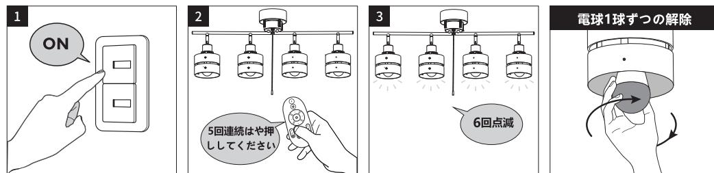
壁スイッチなどで解除したい照明器具の電源を一度切れます。数秒経ってから電源を入れ直します。
