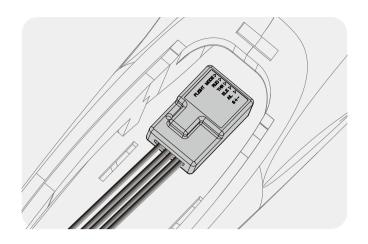
2.撕开维翼背面胶贴,按图示位置粘牢。 注:维翼要和飞机的中心线平行。
